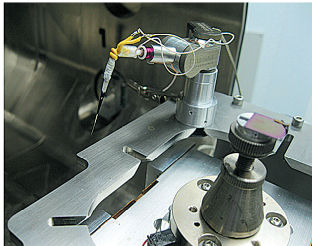
Система наноманипулирования в действии Nanomanipulator in action
