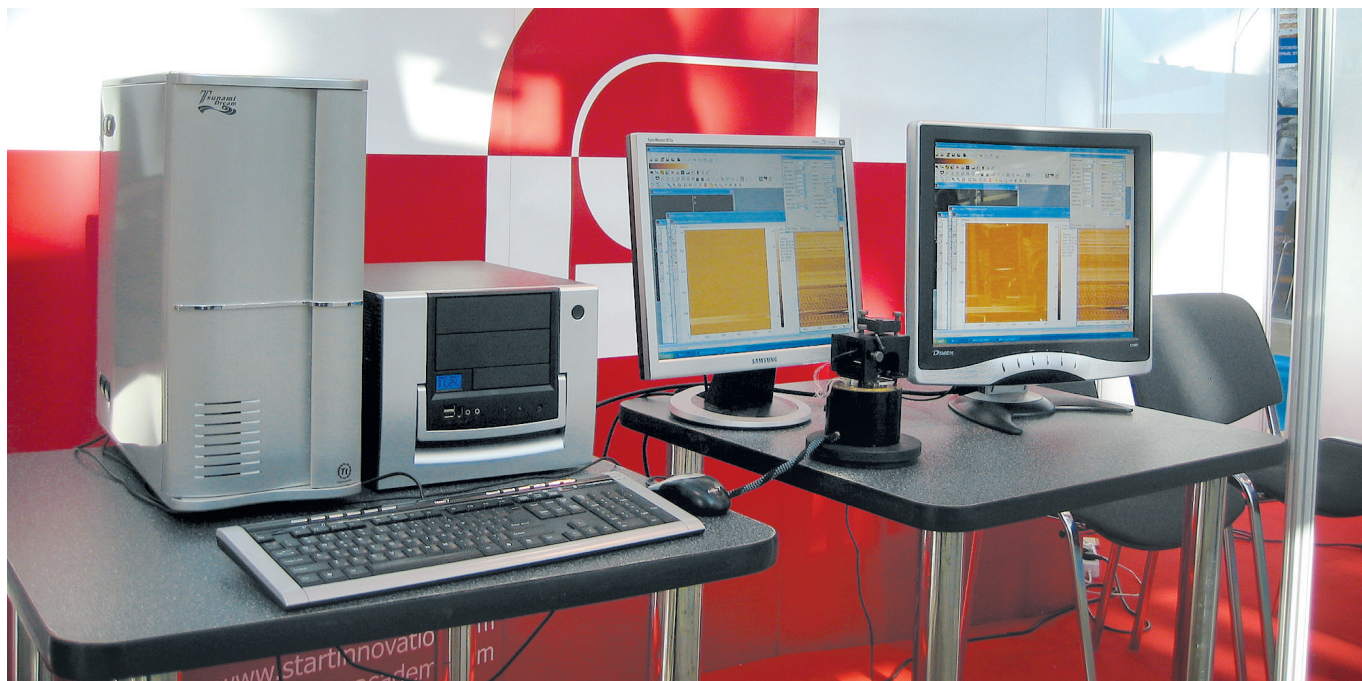
Сканирующий зондовый микроскоп "ФемтоСкан" Scanning probe microscope FemtoScan
