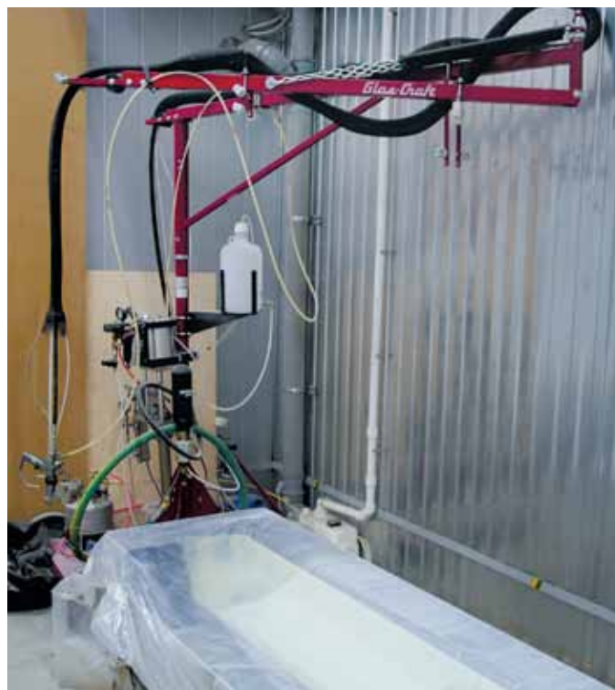
Система напыления The spray lay-up system
