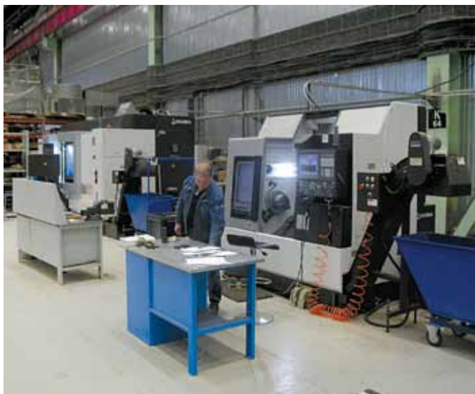
Токарный станок с ЧПУ и многофункциональный токарно-фрезерный обрабатывающий центр CNC lathe and multifunctional turn-mill machining center
