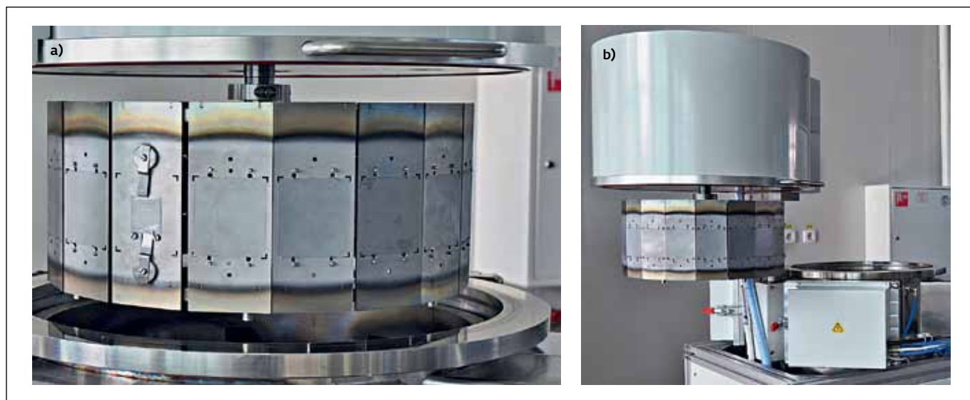
Рис.3. Подложкодержатель (а) и его подъемный механизм (b) Fig.3. Substrate holder (a) and lift mechanism (b)
