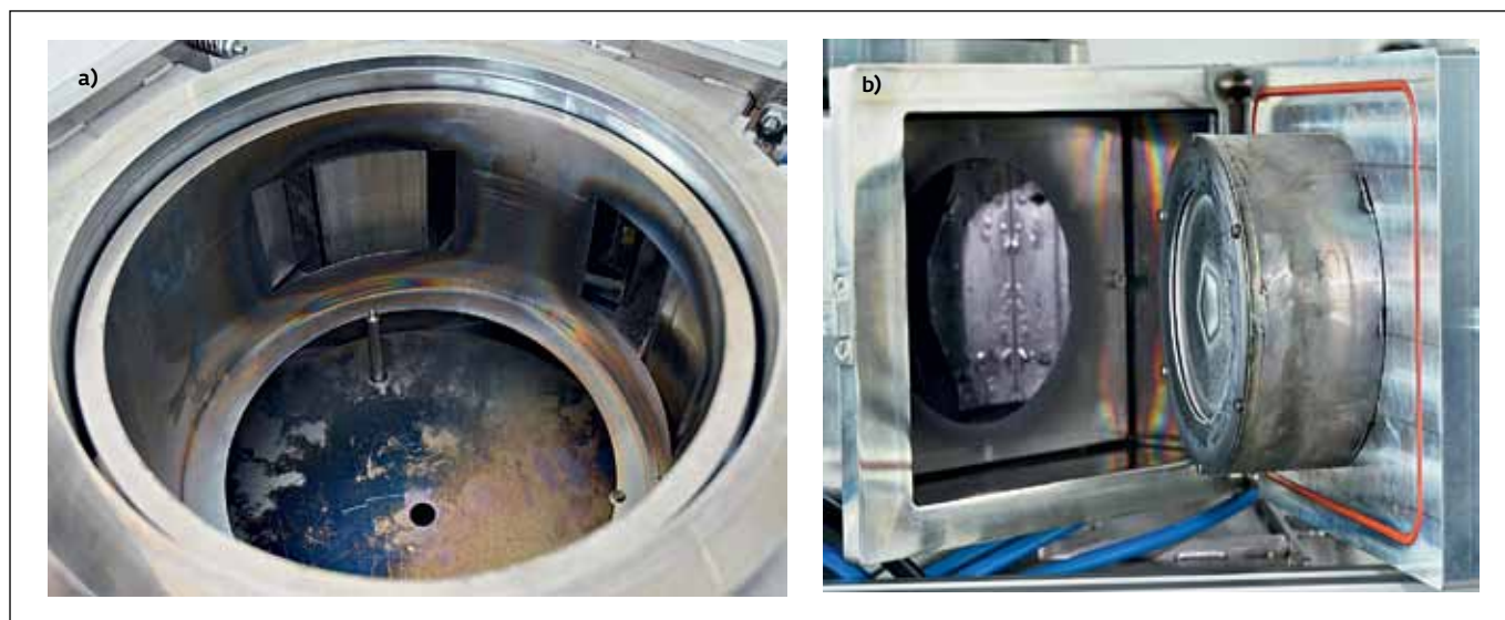
Рис.5. Заслонка (а) и магнетронное распылительное устройство (b) Fig.5. Shutter (a) and magnetron (b)
