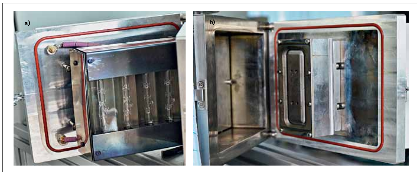
Рис.4. Ламповый нагреватель (а) и ионный источник (б) Fig.4. Lamp heater (a) and ion source (b)
