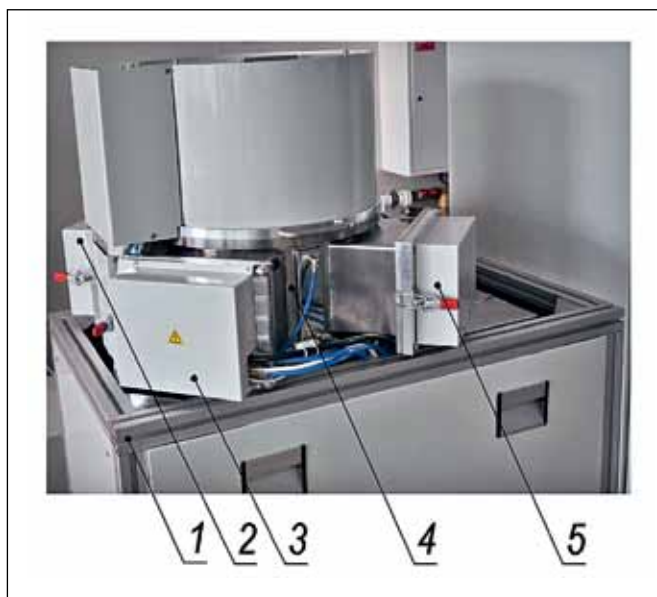
Рис.2. Общий вид технологического модуля установки "Магна ТМ 7": 1 – каркас; 2 – МРУ; 3 – ИИ; 4 – вакуумная камера; 5 – МРУ
