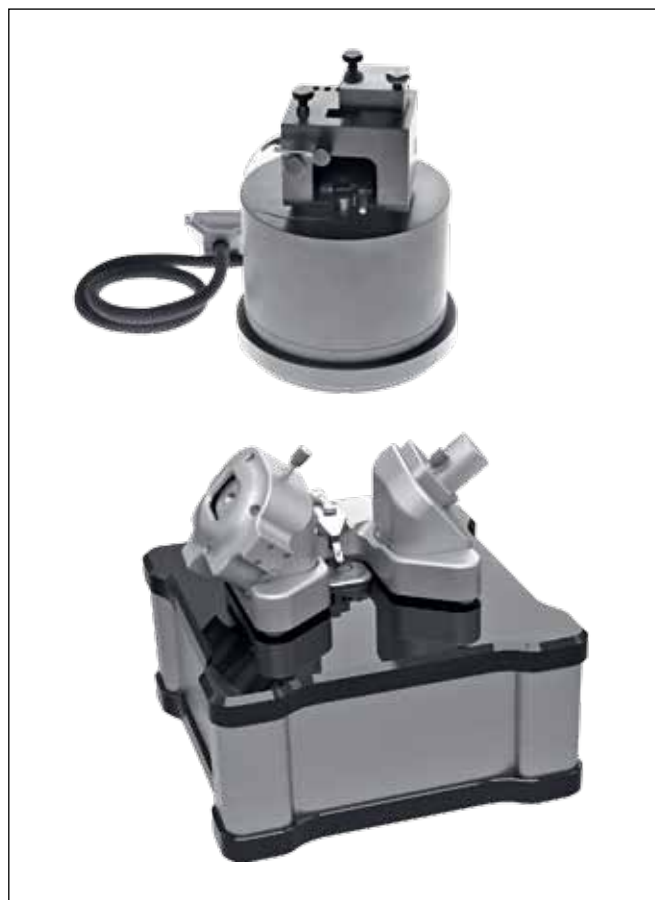
Рис.2. Многофункциональный сканирующий зондовый микроскоп "ФемтоСкан" (сверху) и быстродействующий атомно-силовой микроскоп "ФемтоСкан X" (снизу)
