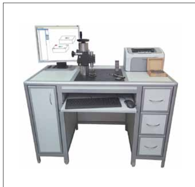
Рис.1. Компаратор для поверки концевых мер длины Fig.1. Gauge block comparator
