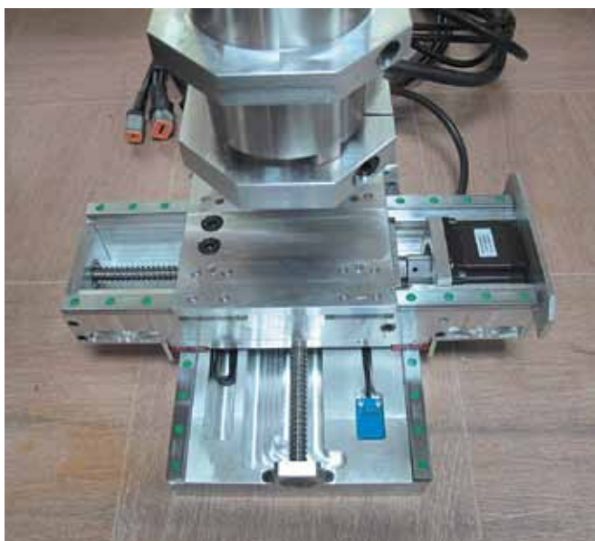
Рис.7. Станок ATCNano с демонтированной гофрозащитой. ШВП и линейные направляющие класса точности C7 в совокупности с бесконтактными датчиками обеспечивают прецизионную точность в обработке даже закаленных сплавов алюминия
