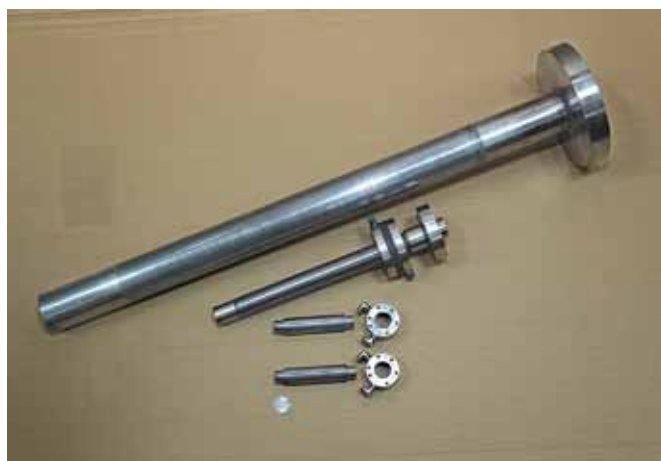
Рис.2. Магнитные винтовые пары диаметром 20, 25 мм и технологический образец винта 50 мм
