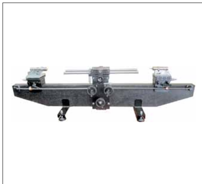
Рис.1. Установка UKM-1000 для поверки концевых мер длины свыше 100 мм
