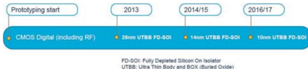
Рис. 2. План развития FDSOI, по данным STMicroelectronics (2014)
