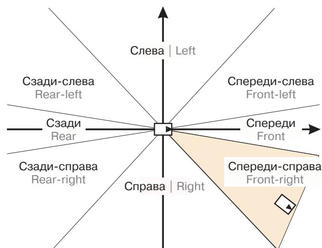
Рис. 3. Иллюстрация определения входной нечеткой переменной «сектор»
