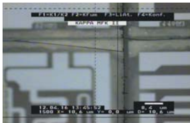
Рис. 7. Линии реза (1) пластины в первом направлении с помощью ЛУТ \text{CO}_2 -лазером и линии реза (2) во втором направлении с предварительным надрезом УФ-лазером (а) и дефект разделения пластины на кристаллы методом ЛУТ (б): отклонение трещины при поперечном резе от линии реза на 100 мкм
