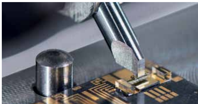
Позиционирование и монтаж линейки линз Lens array alignment & attach
