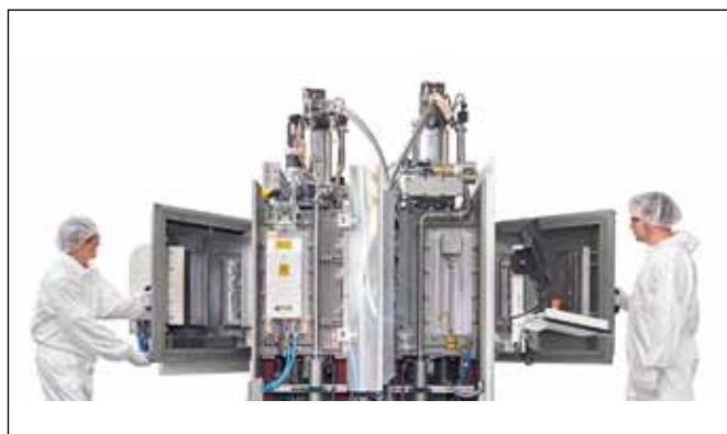
Компактная система напыления серии Boxx с загрузочным шлюзом, вертикально расположенными источниками напыления и магазином барабанного типа
