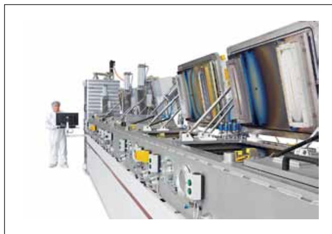
Одношлюзовая напылительная система с горизонтальным расположением камер и магазином для 20 подложек-носителей
