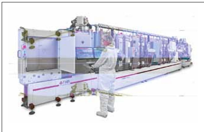
Напылительная система с вертикальным расположением камер, предназначенная для нанесения покрытий (PVD и PECVD)
