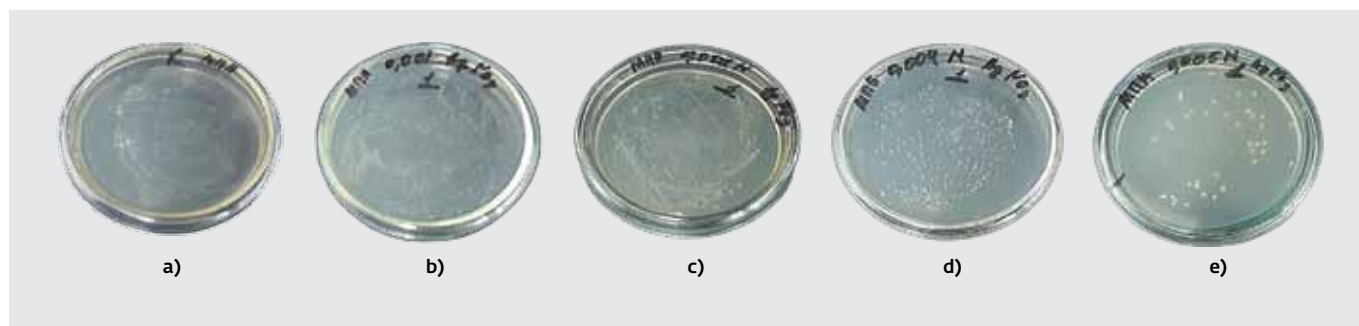
Рис.3. Рост КМАФАНМ. Общее микробное число на контрольном образце упаковочного материала (а) и на образцах, обработанных растворами с разными концентрациями наночастиц серебра (b – 0,001 М; c – 0,002 М; d – 0,004 М; e – 0,005 М) Fig.3. Total viable count on control sample of packaging material (a) and on samples processed with solutions with different concentrations of silver nanoparticles (b – 0.001 M, c – 0.002 M, d – 0.004 M, e – 0.005 M)
