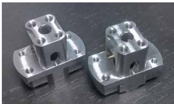
Рис.2. Пример производства мелкой серии: колокола коллекторных прецизионных двигателей, требующие при изготовлении использования шести различных инструментов Fig.2. Example of small batch: bells for precision commutator motors requiring use of six different instruments in manufacturing
