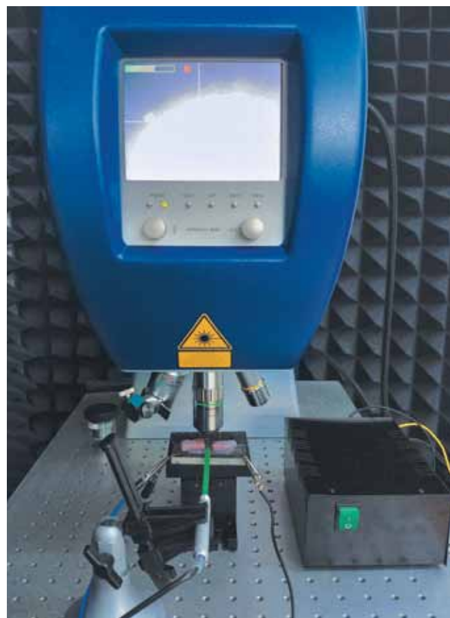
Рис.3. Фотоснимок анализатора MSA-500 со специализированной оснасткой для создания переменного магнитного поля
