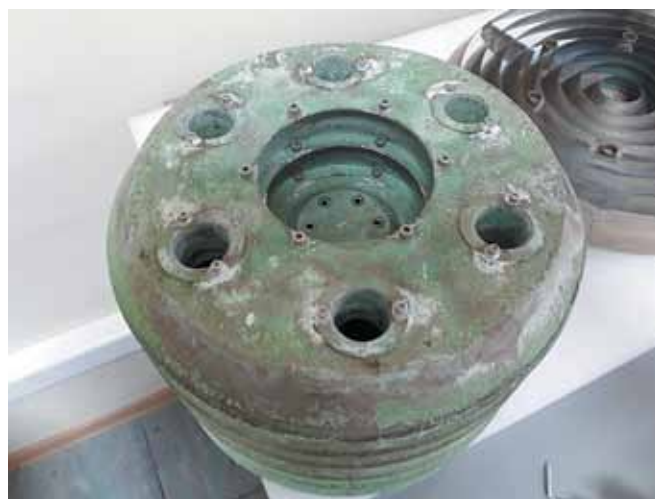
Рис.1. Вторая ступень криогенного насоса до восстановления Fig.1. The second stage of the cryogenic pump before recovery
