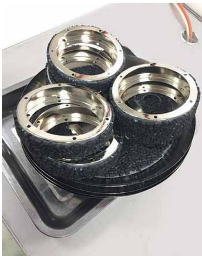
Рис.2. Части второй ступени криогенного насоса после восстановления
