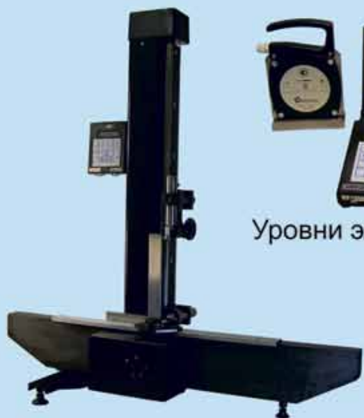
Прибор для поверки угольников ППУ-630
