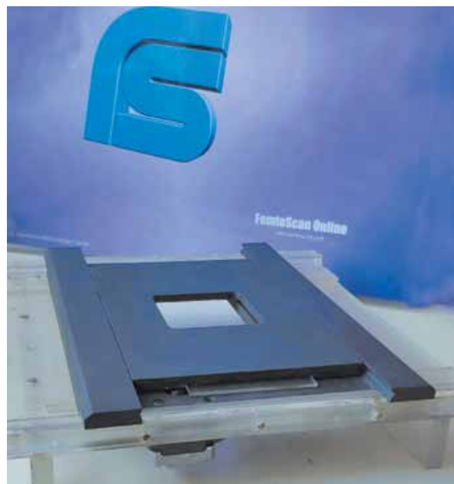
Рис.1. Прототип планарной автоматизированной подвижки 3D-манипулятора с полем позиционирования 100 \times 100 \text{ мм}^2 и встроенным сквозным отверстием Fig.1. A prototype of a planar automated movement of a 3D manipulator with a positioning field of 100 \times 100 \text{ mm}^2 and a built-in through-hole
