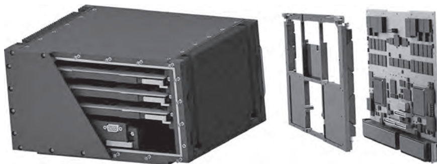
Рис. 1. VPX-система с кондуктивным охлаждением, процессорный модуль (два процессорных узла) с радиатором
