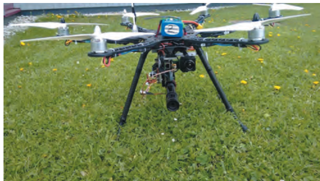
Рис. 2. Малогабаритный дрон с новым типом спектрального оборудования — акустооптическим видеоспектрометром
