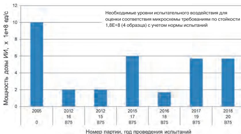
Рис. 2. Результаты контроля производственных партий пластин по подгруппе E1 микросхем 5507БЦ5 серии БМК 5507БЦ (НПК «Технологический центр»)
