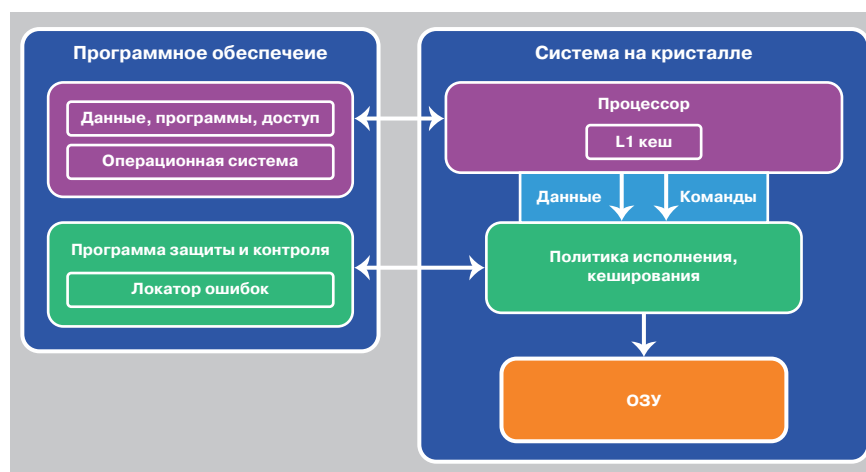
Рис. 2. Контроль ошибок и защита данных СнК на программном уровне [2]
