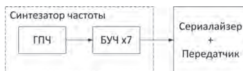
Рис. 6. Архитектура двухступенчатого синтезатора для видеоконтроллера
