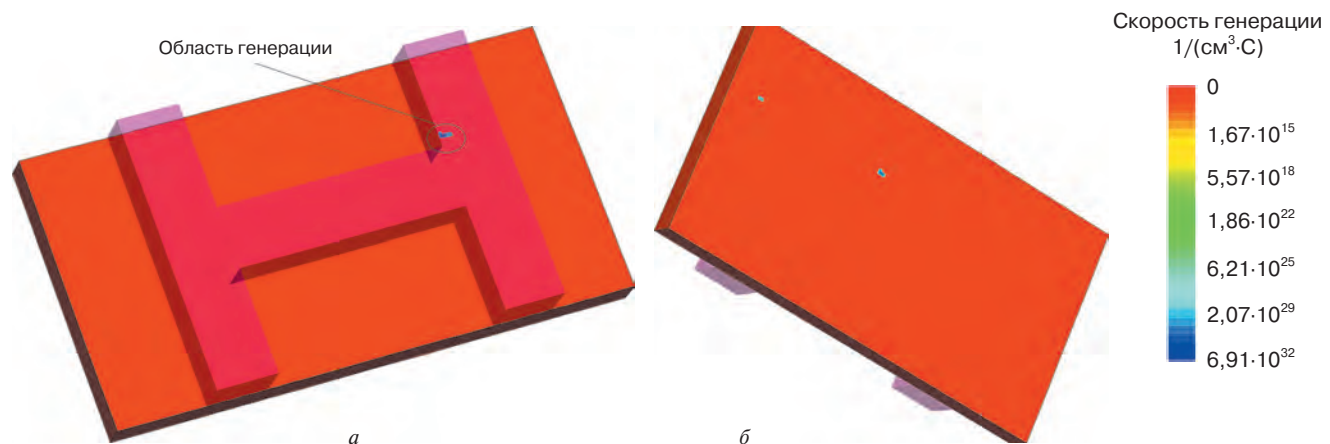
Рис. 6. Распределение скорости генерации носителей заряда в момент воздействия ионов ( t = time ): а) вид сверху, б) вид со стороны оксидного слоя
