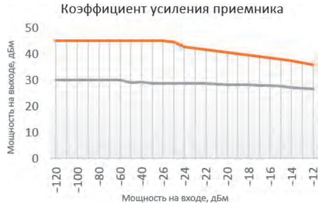
Рис. 8. Коэффициент усиления приемника (красный график — до оптимизации, серый — после оптимизации)
