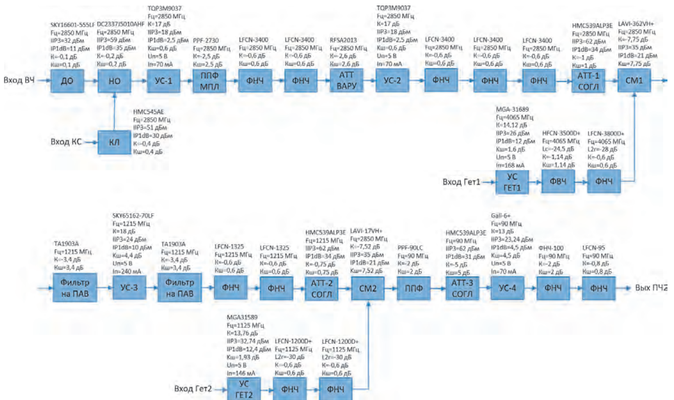
Рис. 4. Детализированная функциональная схема приемного канала многоканального приемного устройства
