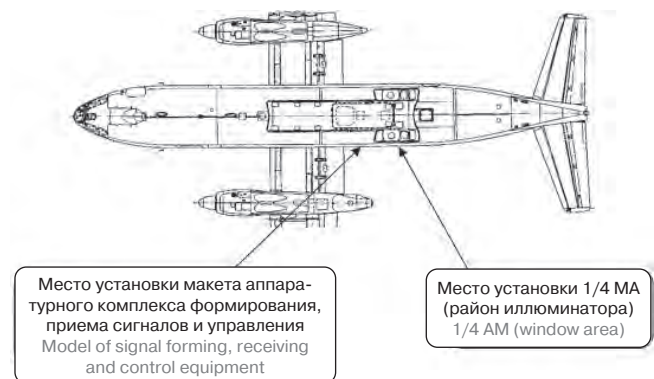
Рис. 3. Размещение исследуемого макета БСК внутри фюзеляжа самолета-лаборатории
