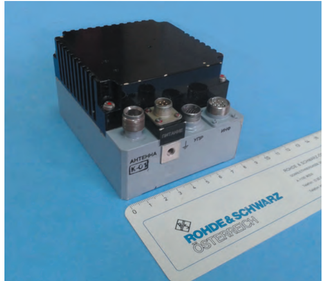
Рис. 1. Радиопередающее устройство на импортных электронных компонентах
