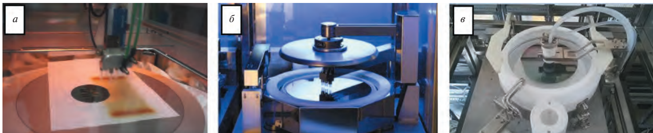
Рис. 3. Позиции нанесения фоторезиста: а) оборудование Sawatec iSpray-300; б) оборудование Suss ACS300 Gen2 с крышкой GYRSET; в) оборудование ОАО «НИИПМ»
