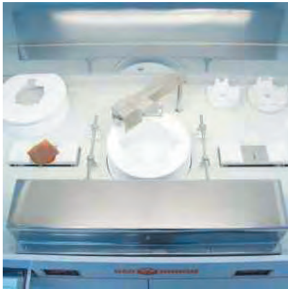
Рис. 2. Технологическая позиция установки химической обработки УХО-153
