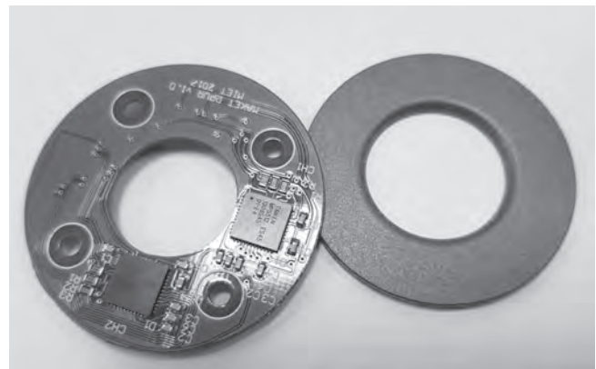
Рис. 3. Макет датчика: слева плата, справа кодовый магнитный диск, внешний диаметр диска 40 мм
