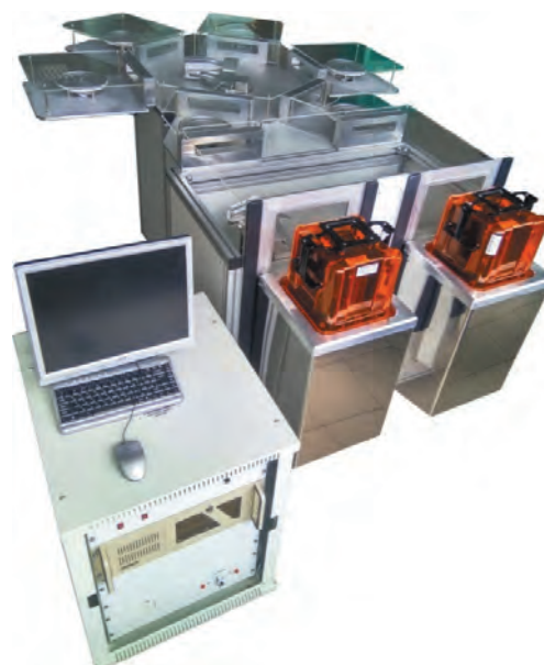
Рис. 19. Транспортно-загрузочная система пластин диаметром 200 мм с использованием СМIF-контейнеров
