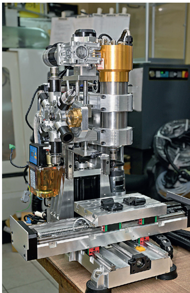
Рис.4. Обрабатывающий центр АТС "Индустрия 4.0"
