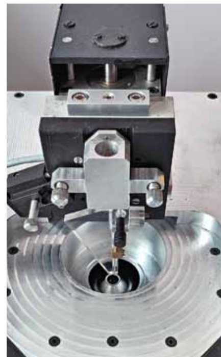
Рис.1. Изображение совмещенного атомно-силового и сканирующего капиллярного микроскопа, установленного на инвертированном оптическом микроскопе Nikon Eclipse Ti: общий вид – слева, механическая головка сканирующего капиллярного микроскопа – справа
