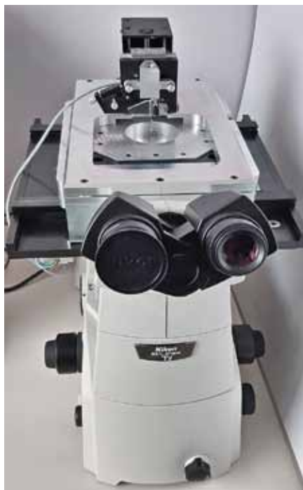
Рис.1. Изображение совмещенного атомно-силового и сканирующего капиллярного микроскопа, установленного на инвертированном оптическом микроскопе Nikon Eclipse Ti: общий вид – слева, механическая головка сканирующего капиллярного микроскопа – справа
