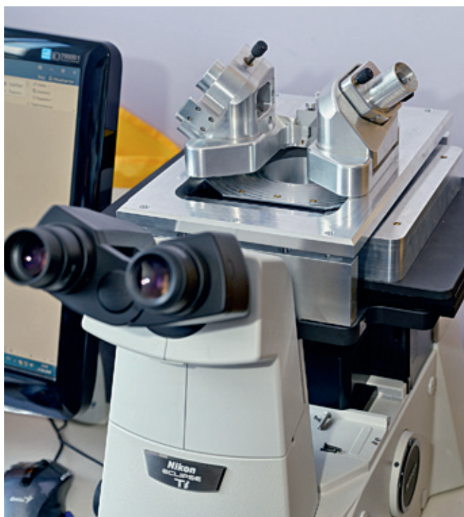
Установка для зондовой микроскопии на базе оптического инвертированного микроскопа Nikon Ti-U Probe microscopy unit based on Nikon Ti-U optical inverted microscope
