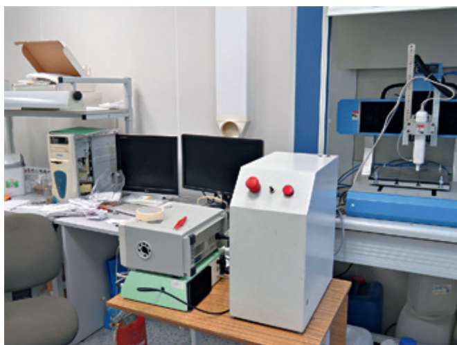
Рис.1. Экспериментальная установка. НЧ-плазмотрон смонтированный на ЧПУ
