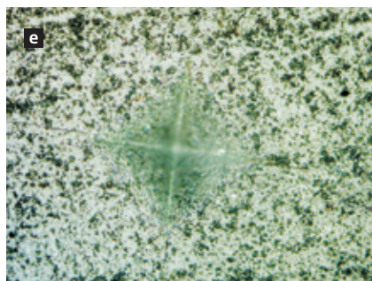
Рис.1. Микрофотографии пластических отпечатков на различных материалах
