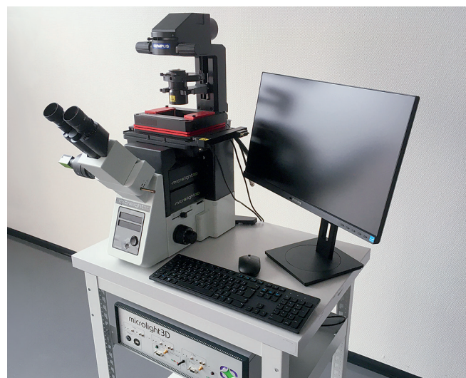
μFAB-3D – система трехмерной печати ультра-высокого разрешения на основе технологии двухфотонной полимеризации μFAB-3D – ultra-high resolution 3D-printing system, based on two-photon polymerization direct laser writing technology
