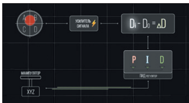
Рис.5. Схема обратной связи атомно-силового микроскопа с использованием ПИД-регулятора
