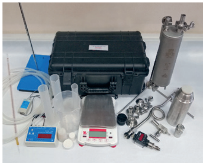
Рис.8. Комплект для квалификации систем чистого пара KIT ASEPTICA CLEAN STEAM
