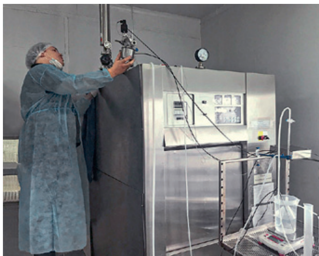
Рис.7. Подключение комплекта в точке потребления у автоклава для отбора проб
