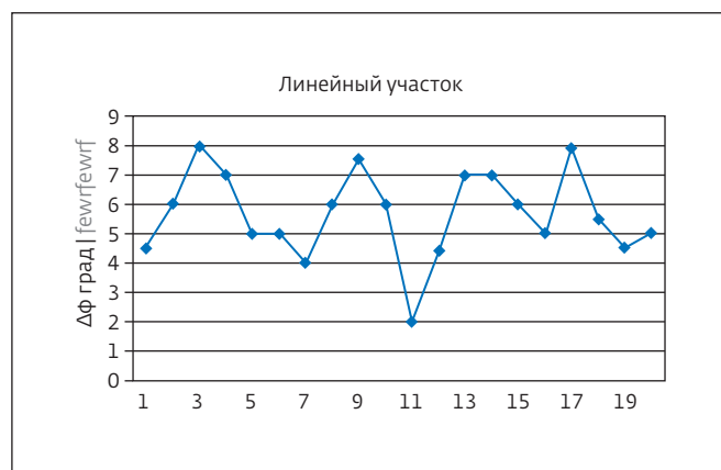
Рис.1. Распределение равномерности интерференционных полос в выходной апертуре интерферометра при \Delta x = 100 мм Fig.1. Distribution of the interference bands uniformity in the output aperture of the interferometer at \Delta x = 100 mm
