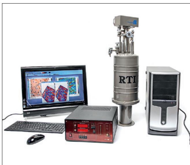
Рис.1. "ФемтоСкан Крио" регистрирует силы с помощью кварцевого камертона, поэтому в системе отсутствует лазерный луч и источники тепловых помех
