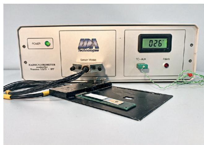
Рис.3. Сверху – СЗМ "ФемтоСкан", снизу – контрольный блок и держатель с сенсором прибора "Нанокалориметр"
