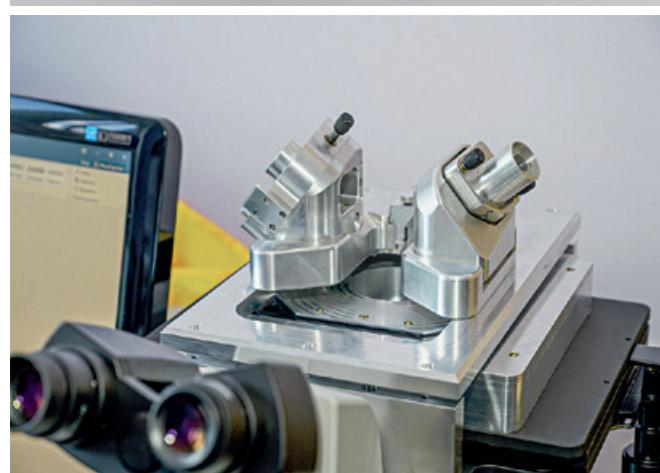
Рис.2. Сверху – "ФемтоСкан X", высокоскоростной сканирующий зондовый микроскоп для биологии и медицины. Снизу – "ФемтоСкан Xi" на базе инвертированного оптического микроскопа
