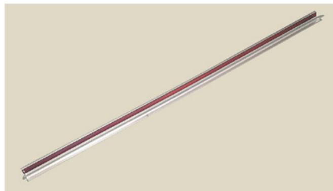
Рис.4. Голографическая дифракционная решетка с длиной L = 1200 мм и общим количеством штрихов – 1 200 000 Fig.4. Holographic diffraction grating with length L = 1200 mm and total number of lines of 1 200 000
