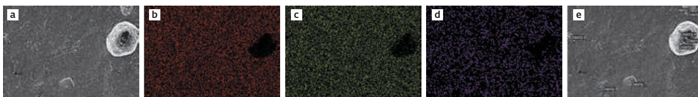
Рис.7. Карта распределения элементов на образце сплава Ti_{49.0}Ni_{51.0} в крупнозернистом состоянии в растворе 3М HCl: a – изображение во вторичных электронах; b – распределение титана; c – распределение никеля; d – распределение хлора; e – изображение во вторичных электронах с указанием спектров на образце
