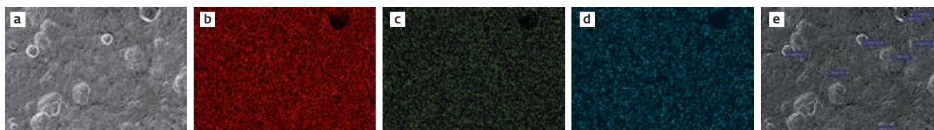
Рис. 17. Карта распределения элементов на образце сплава Ti49,0Ni51,0 в ультрамелкозернистом состоянии с предварительным старением после коррозионных испытаний в 3М H 2 SO 4 : a – изображение во вторичных электронах; b – распределение титана; c – распределение никеля; d – распределение серы; e – изображение во вторичных электронах с указанием спектров на образце Fig. 17. Map of the distribution of elements on the sample of the Ti49.0Ni51.0 alloy in the ultrafine-grained state with preliminary aging after corrosion tests in 3M H 2 SO 4 : a – image in secondary electrons; b – distribution of titanium; c – nickel distribution; d – distribution of sulfur; e – image in secondary electrons with indication of the spectra on the sample
