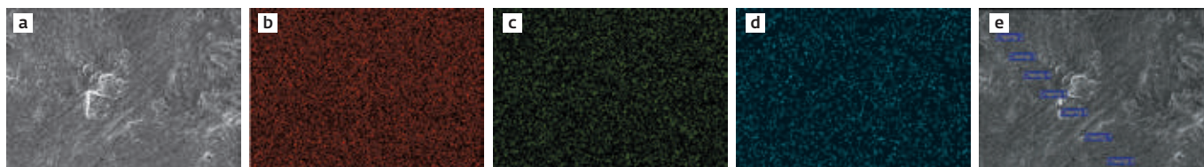
Рис.13. Карта распределения элементов на образце сплава Ti49,0Ni51,0 в крупнозернистом состоянии после коррозионных испытаний в 3М H 2 SO 4 : а – изображение во вторичных электронах; б – распределение титана; с – распределение никеля; д – распределение серы; е – изображение во вторичных электронах с указанием спектров на образце Fig.13. Map of the distribution of elements on the sample of Ti49.0Ni51.0 alloy samples in a coarse-grained state after corrosion tests in 3M H 2 SO 4 : a – image in secondary electrons; b – distribution of titanium; c – nickel distribution; d – distribution of sulfur; e – image in secondary electrons with indication of the spectra on the sample
